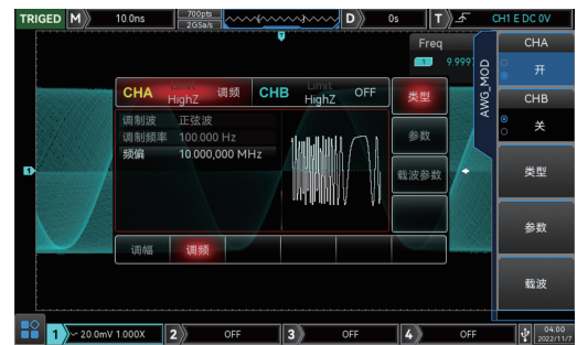
10 内置高性能双通道50MHz函数/任意波形发生器
