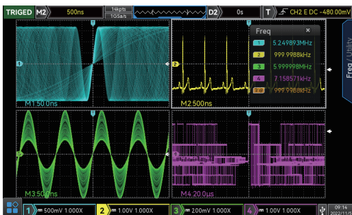
5 Multi-Scopes 2.0支持独立触发，相当于四台单独独立荧光示波器，支持多种分屏显示
